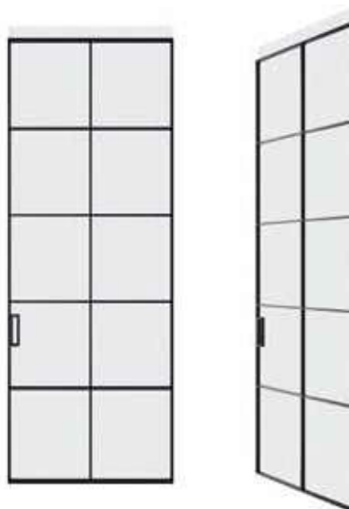
DIV - LTT Anta Intelaiata con listelli tutti trasversali - Framed panel with horizontal cross profiles only - Gerahmte Tür nur mit Querleisten
